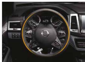
Servosterzo elettrico ad assistenza variabile in funzione della velocità e volante in pelle riscaldabile
