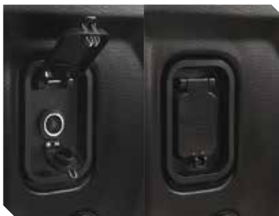
Presa di corrente nel vano cassone
