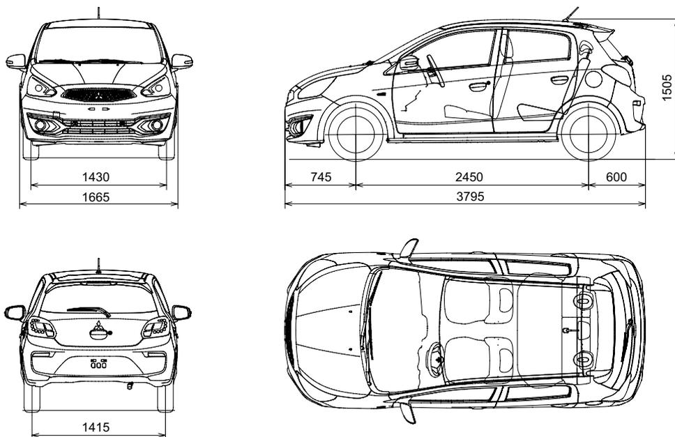
Misure in millimetri
